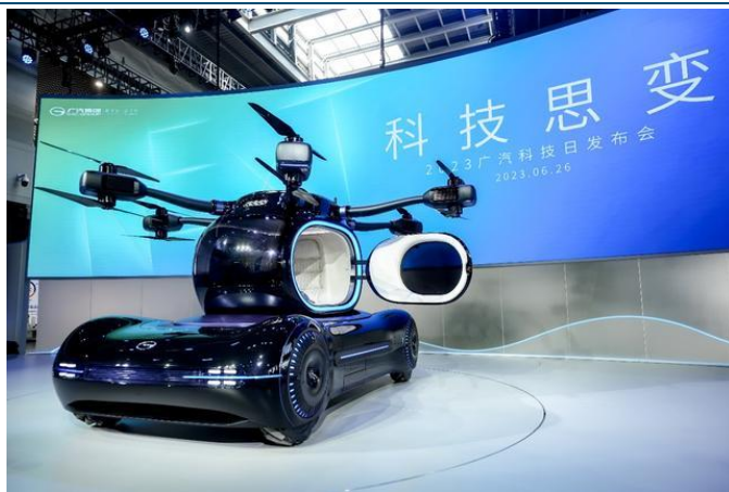
图表1: 广汽飞行汽车 GOVE 采用分离式机体构型
