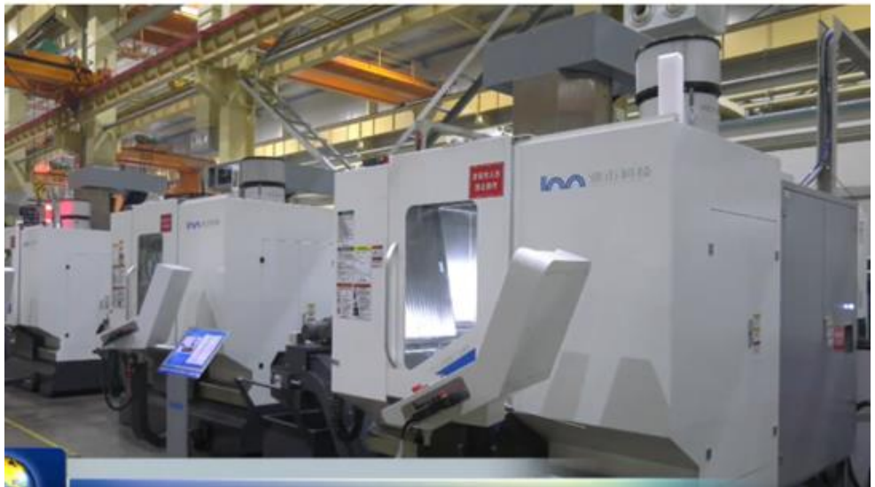
图26：豪迈科技工厂内使用自主研发的五轴数控机床
