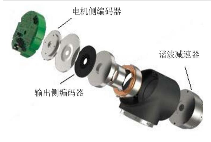
图30：协作机器人关节模组中采用双编码器
