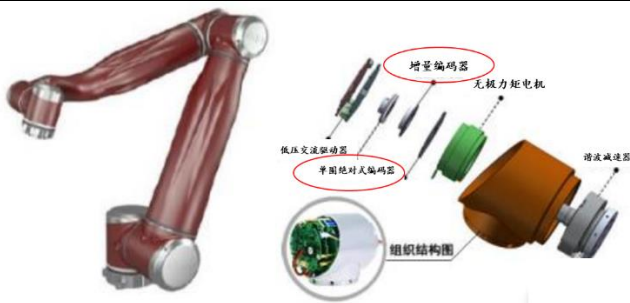
图22：协作机器人及其关节构造
