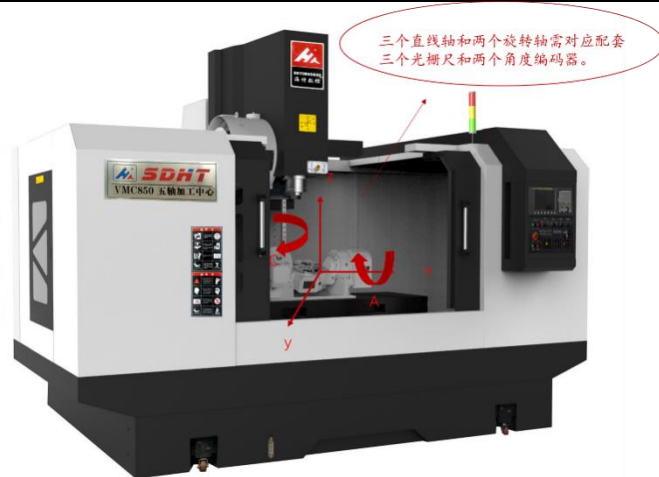
图18: 五轴数控机床需配套三个光栅尺和两个角度编码器
