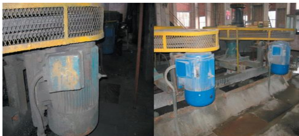
图41 普通三相异步电动机（左）与稀土电机（右）
