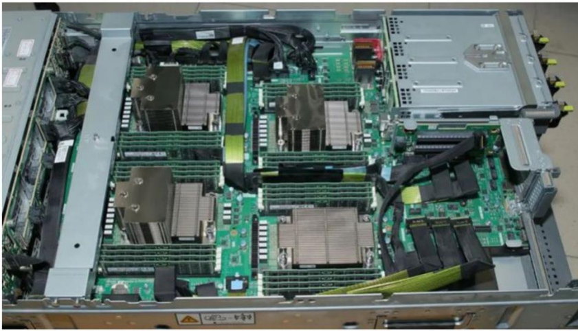
图 32: 华为 Atlas 800 训练服务器内部结构图
