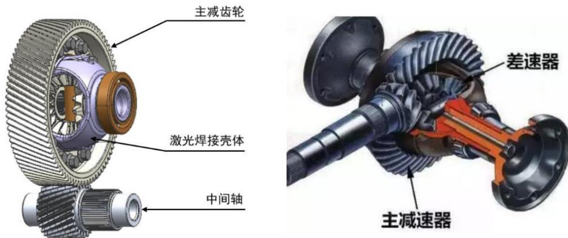
图23：主减速器通常与差速器总成配合使用
