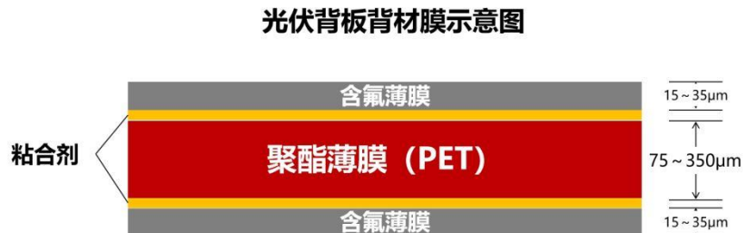
图21：光伏背板背材通常由三层结构组成：中间层聚酯薄膜、内外两层含氟薄膜
