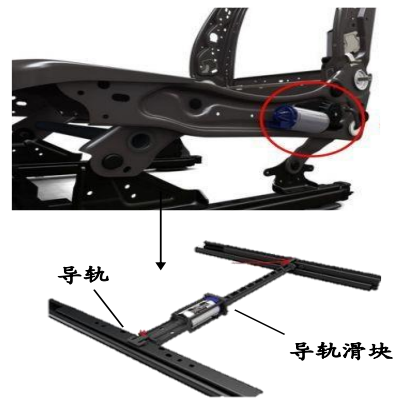
图12：丝杠导轨在汽车座椅调节系统中的应用
