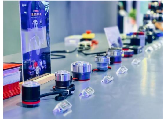
图表8: 达闼柔性关节执行器
