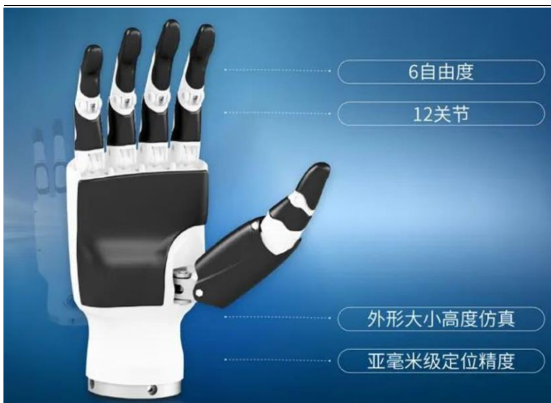
图4：单只 6 自由度的机器人机械手可能使用了 1 个或 2 个控制器
