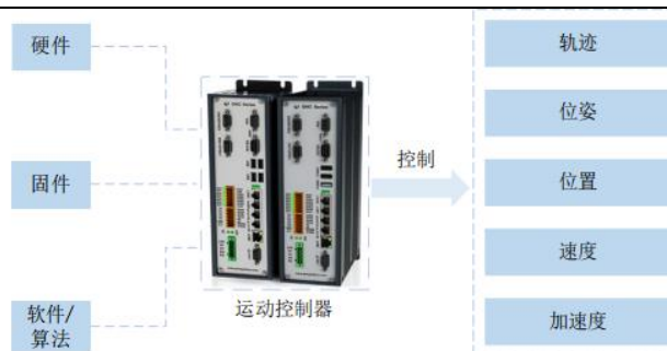
图1：控制器的基本结构包括硬件、固件、算法
