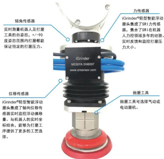
图表20: 宇立和金恒通过力/位置混合控制打造的智能力控打磨方案
