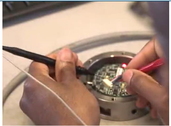
图表28: ATI 六轴力矩传感器人工安装过程
