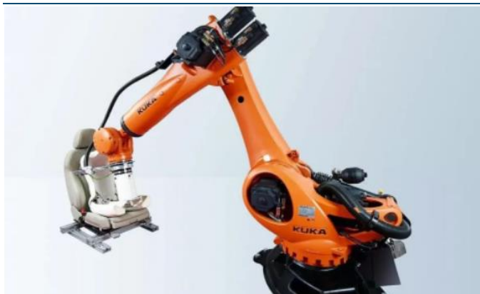
图表17: ATI 力控传感器汽车座椅测试应用
