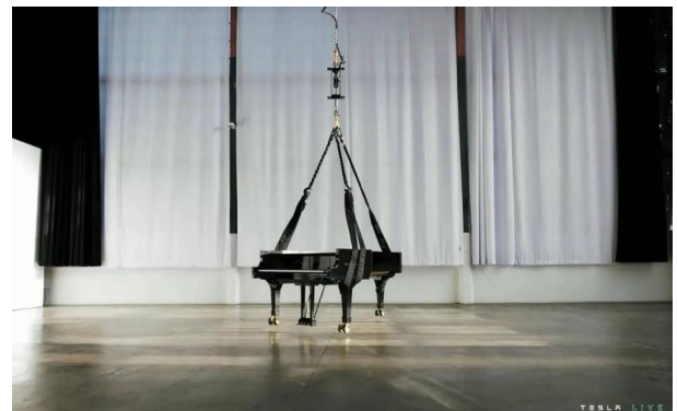
图8. 特斯拉通过用单个线性执行器拉起一架半吨的钢琴
