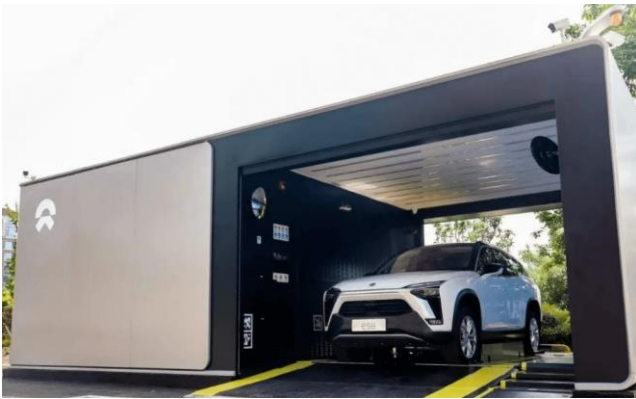
图 32：蔚来乘用车换电站
