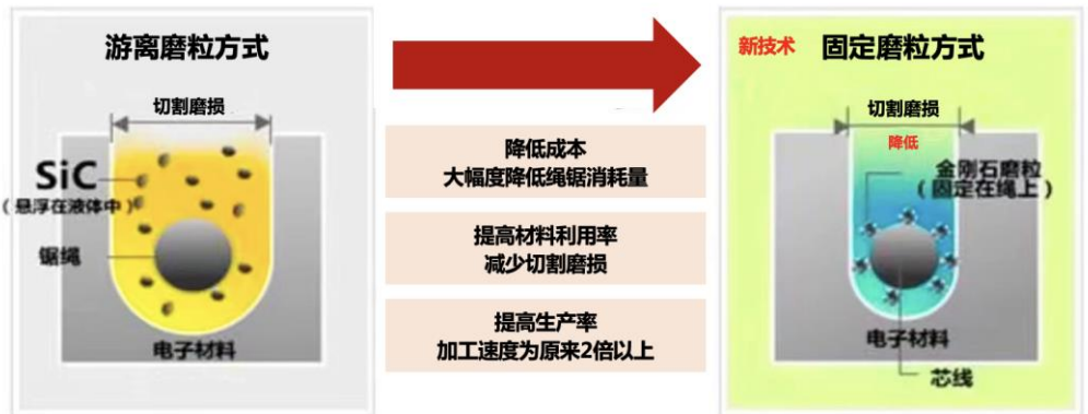
图10: 游离磨料切割与金刚线切割工艺图
