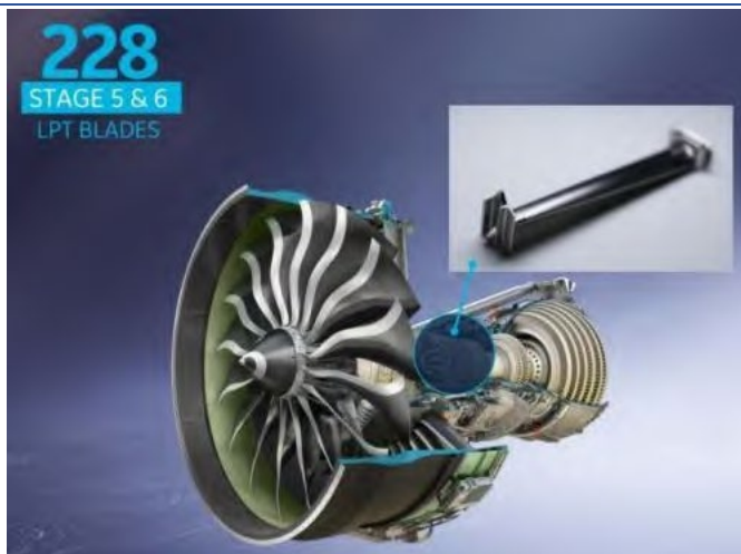
图表 16: GE9X 发动机采用 EBM 制备 TiAl 合金低压涡轮叶片
