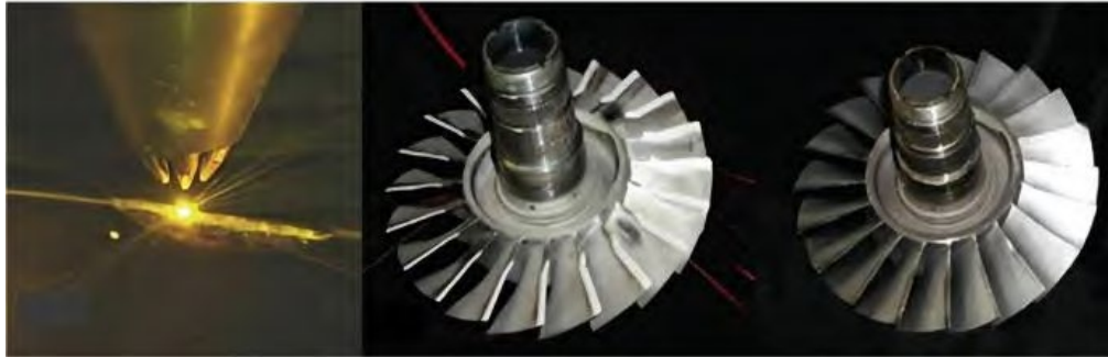
图表 18: 增材修复在航空发动机整体叶盘上的应用
