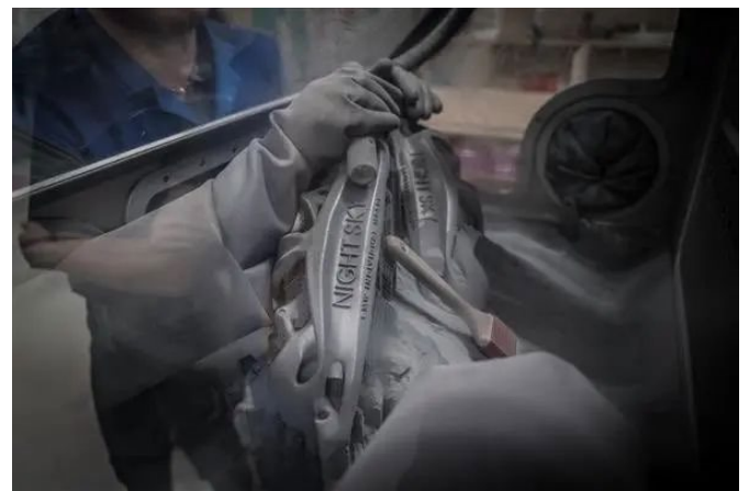
图表 21：宝马开发 M850i 夜空特别版 3D 打印刹车卡钳
