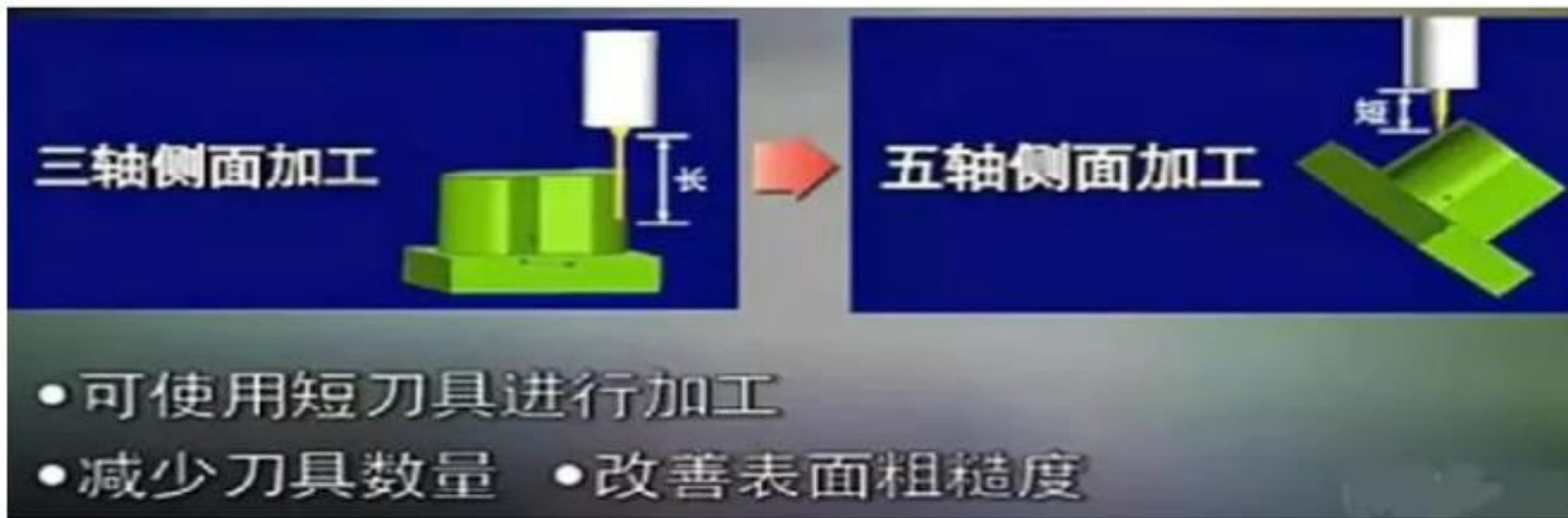
图 21: 五轴侧面加工的优势
