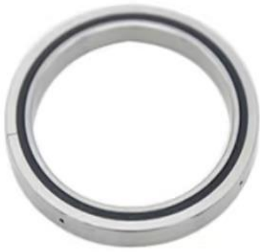
图表17: 交叉滚子轴承的结构使其能承受各方向的载荷, 刚性提高3-4倍
