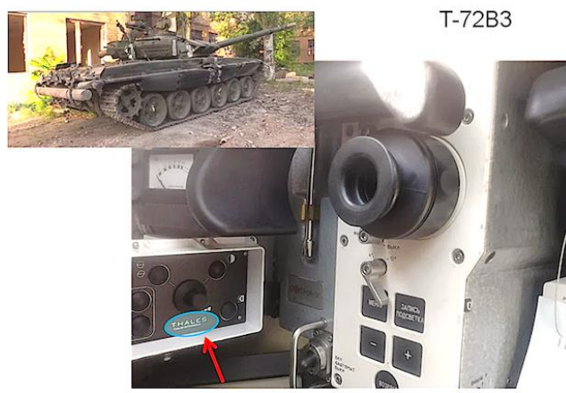
图 8：装备法国热像仪的俄罗斯 T-72B3 坦克
