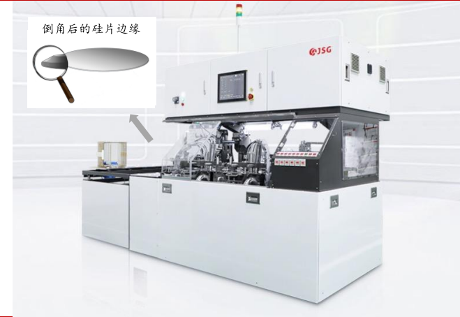
图7：倒角机示意图
