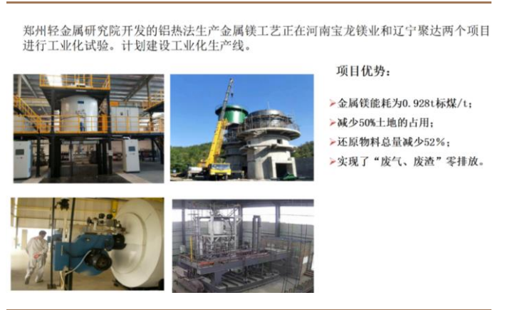
图 28：铝热法生产金属镁能降耗减排
