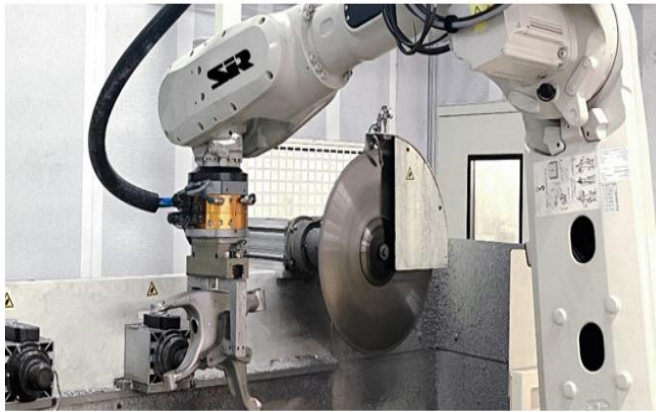
图 37: 希尔机器人为客户定制机器人切割去毛刺单元
