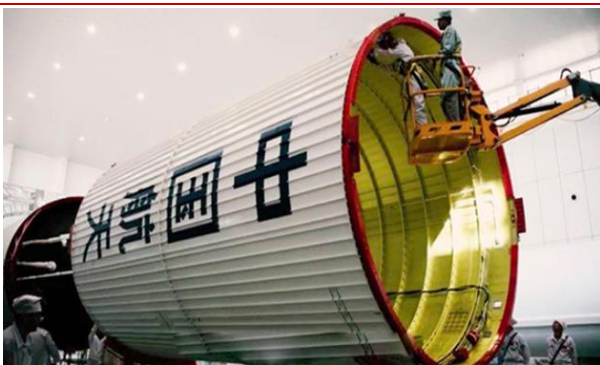
图29: 红色环状部分为运用公司高分子增材制造技术制造出的级间解锁装置保护板
