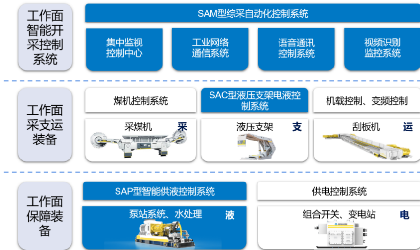
图 3：无人化智能采煤控制系统解决方案
