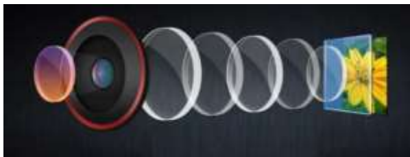
图表 5 主流手机镜片构成示意图
