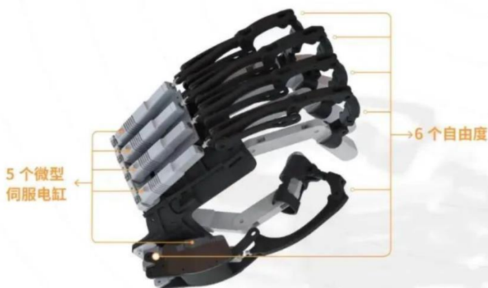
图表36：因时机器人灵巧手内部结构
