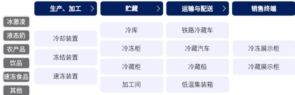
图 12: 冷链主要对应设备
