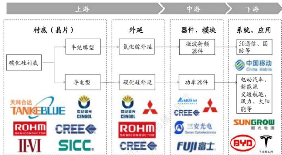
图表 34 SiC 产业链及主要工序
