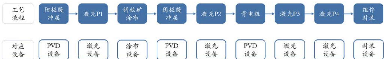
图表 50 协鑫光电公布的钙钛矿工艺流程图
