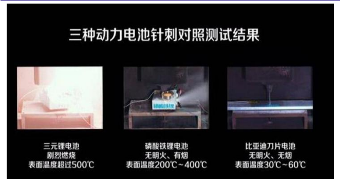
图 40：刀片电池具有出色的安全性
