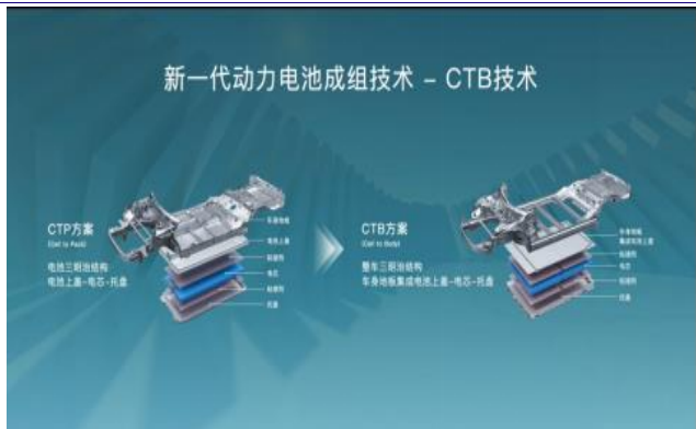
图 57: CTB 技术提升电池体积利用率
