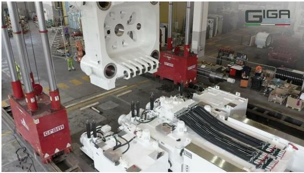
图 55: 特斯拉一体化压铸机
