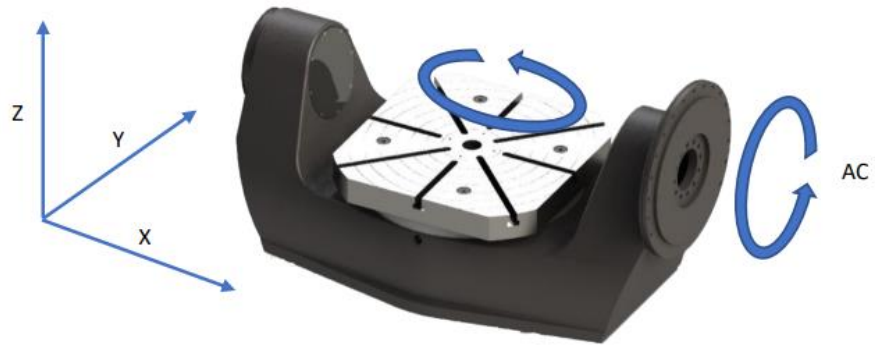
图24：五轴联动示意图
