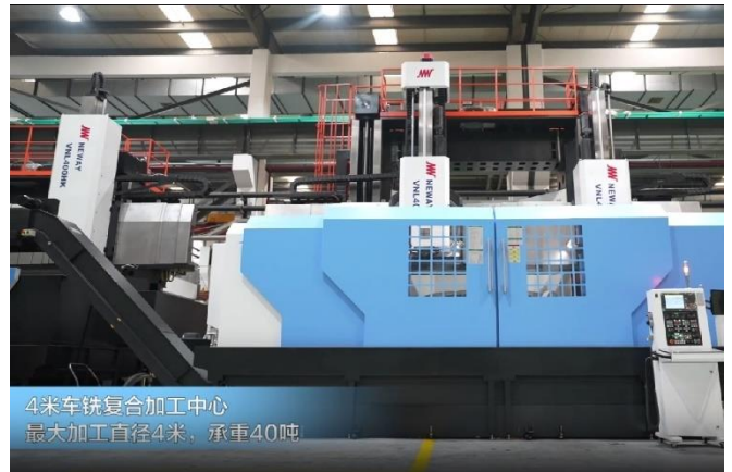
图18: 公司新产品——新一代立式车削中心 VNL400HT
