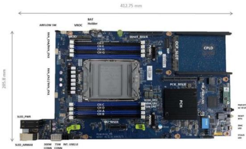
图 24: MiTACAowanda1S1RU 底座主板
