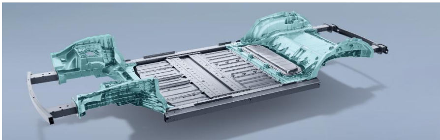
图：前后一体化铝压铸技术
