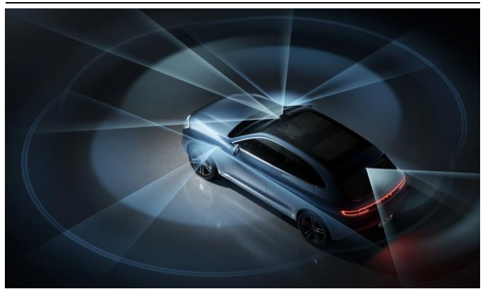
图14: 华为 ADS2.0, 全车优化至 27 个感知硬件
