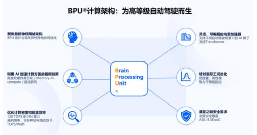
图32：地平线 BPU 计算架构，实现算法效率、灵活性和硬件效率的最优解
