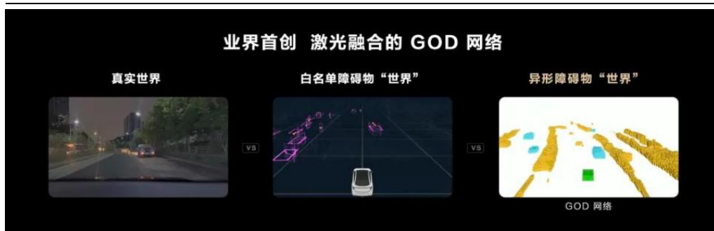
图16: 华为 GOD 网络实现了激光雷达、毫米波雷达、摄像头等多传感融合
