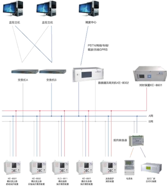
图 26 KLD-9300 变电站计算机监控系统
