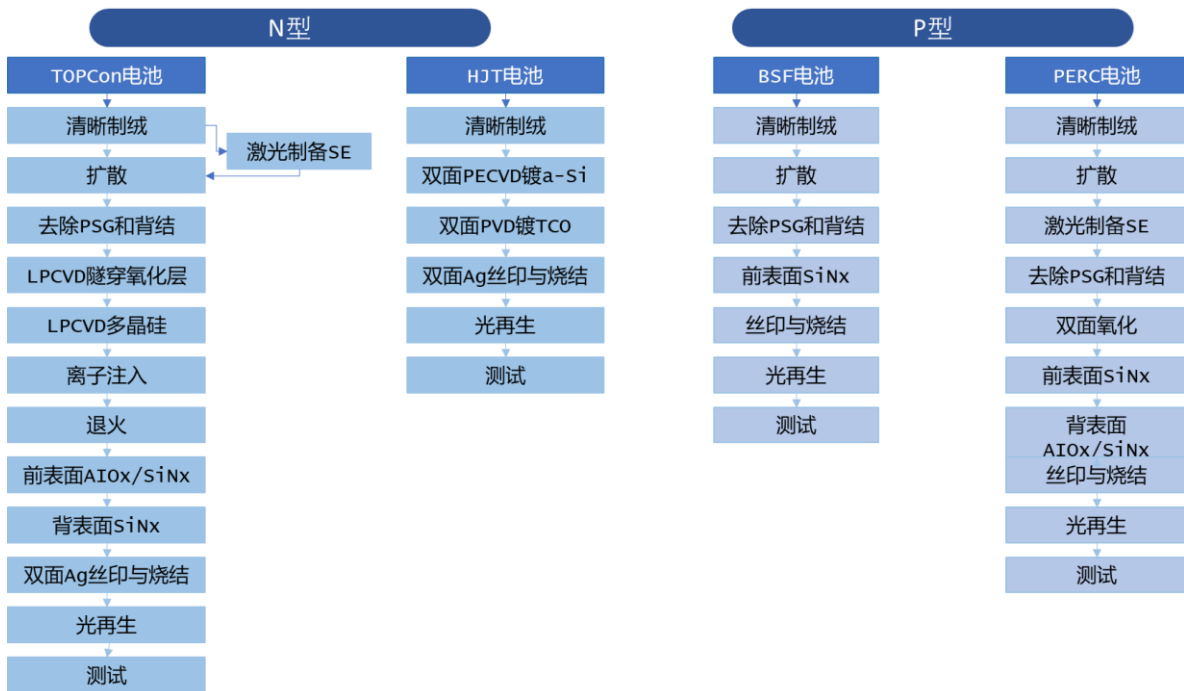
图表 28：不同技术电池片生产流程
