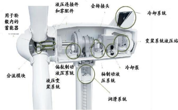
图表37: 液压变桨结构示意图
