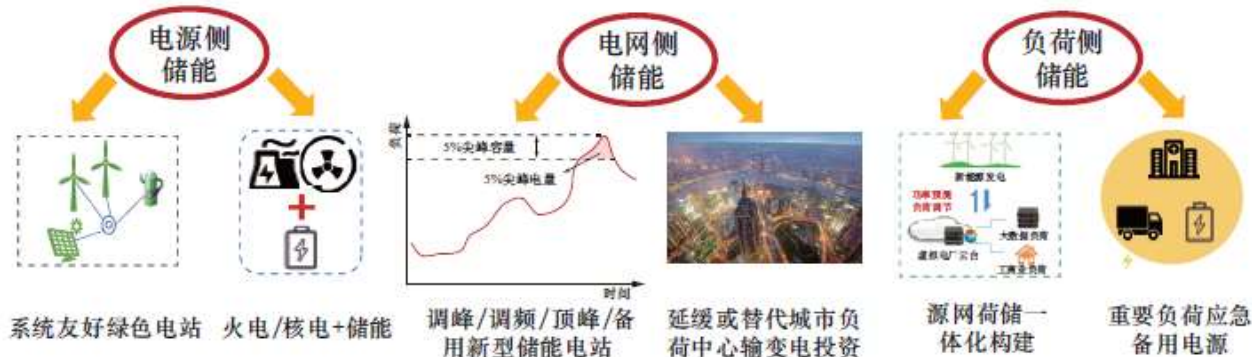
图：源网荷各侧新型储能应用场景
