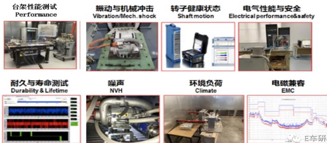
图：六相冗余EPS电机试验验证过程
