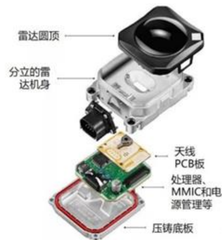
图：博世第三代毫米波雷达构成
