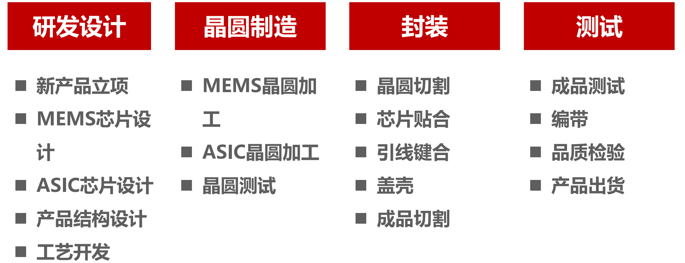
图：MEMS传感器工艺流程图
