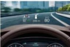
W-HUD<br>(挡风玻璃抬头显示)  | 前挡风玻璃   | 仪表+中控      | 4-5米   | 较多：车况、车速等  | 无色差      | TFT技术或DLP技术        | 15,000cd/m <sup>2</sup> | L0-L3    | 1,200-2,000 | 光学结构复杂，成本高 | 已实现量产，市场主流  | 东风日产启辰星、哈弗大狗、蔚来ET7、理想L9等 |
