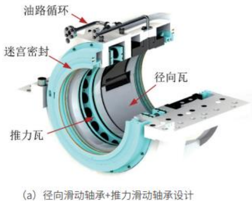
图32：径向+推力设计使滑动轴承有承受非扭载荷能力
