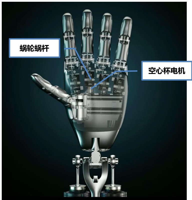
图23：特斯拉人形机器人灵巧手结构设计
