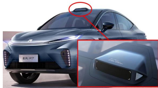
图：飞凡R7激光雷达方案
