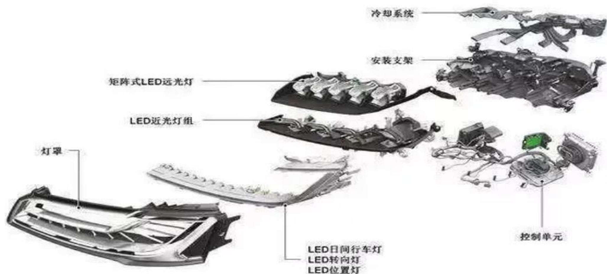
图：传统LED车灯系统结构
