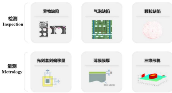
图25: 量/检测设备主要包括检测和量测设备两大类
