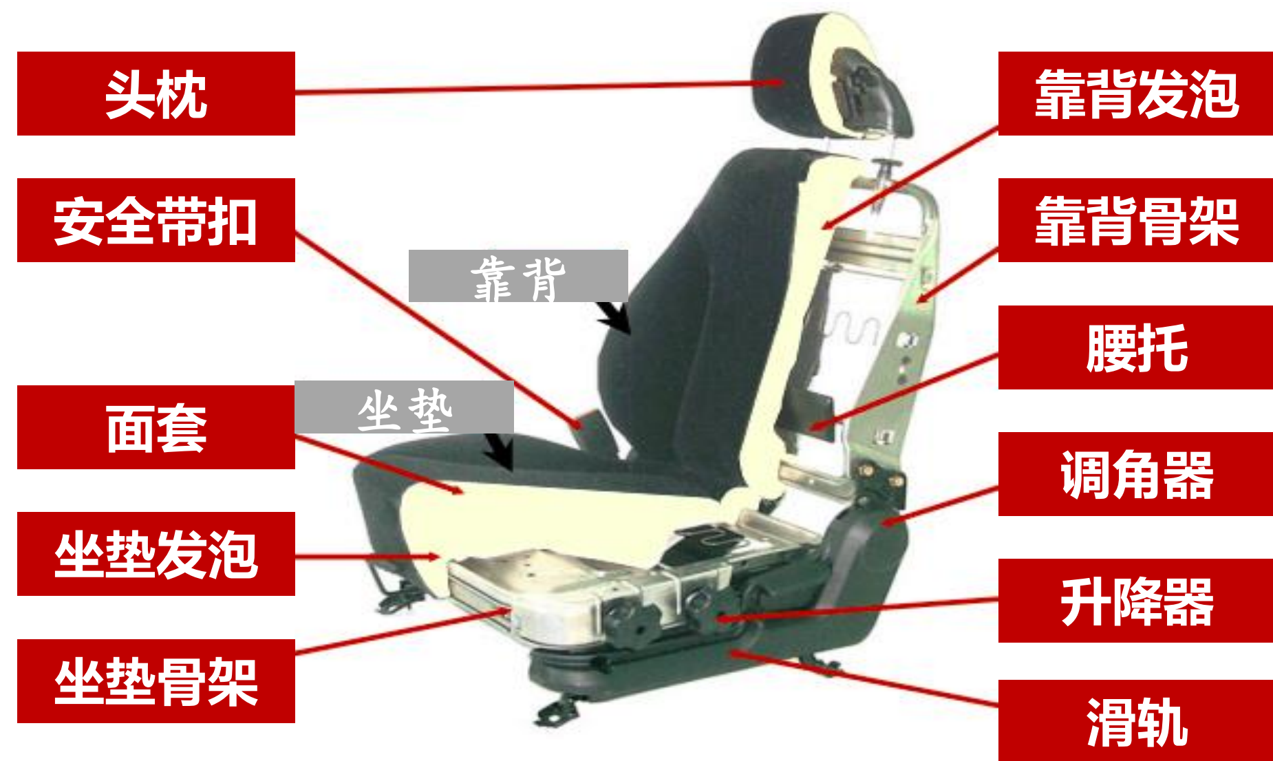
图：乘用车座椅结构
