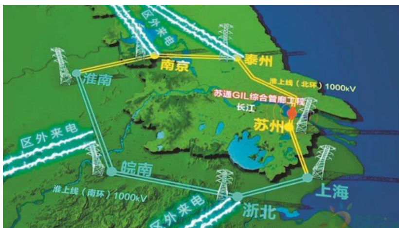
图表15：安徽主要通过两条交流特高压线路对江浙沪进行电力保供
