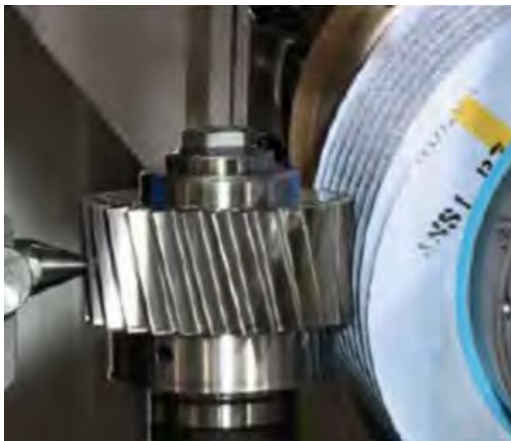
图15：磨齿加工示意图
