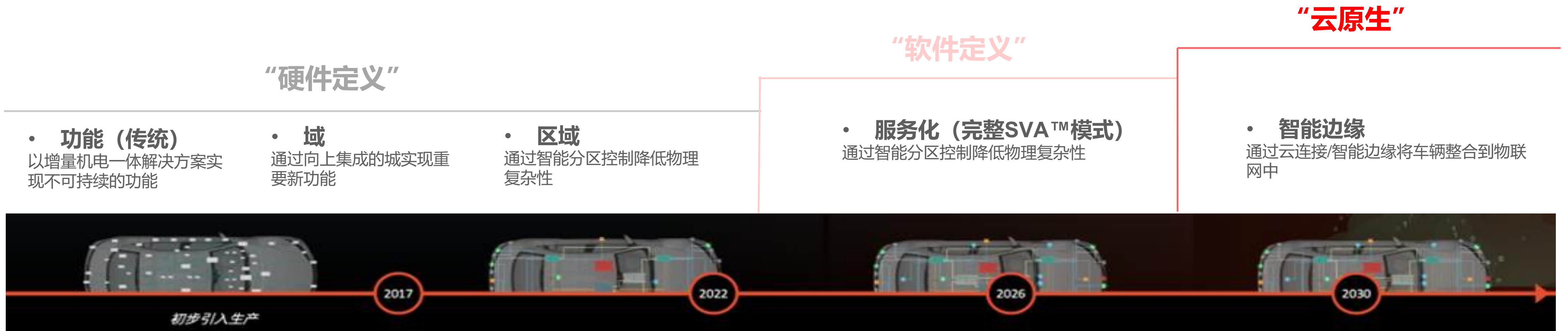
图：安波福提出的汽车电子电气架构演变路径
