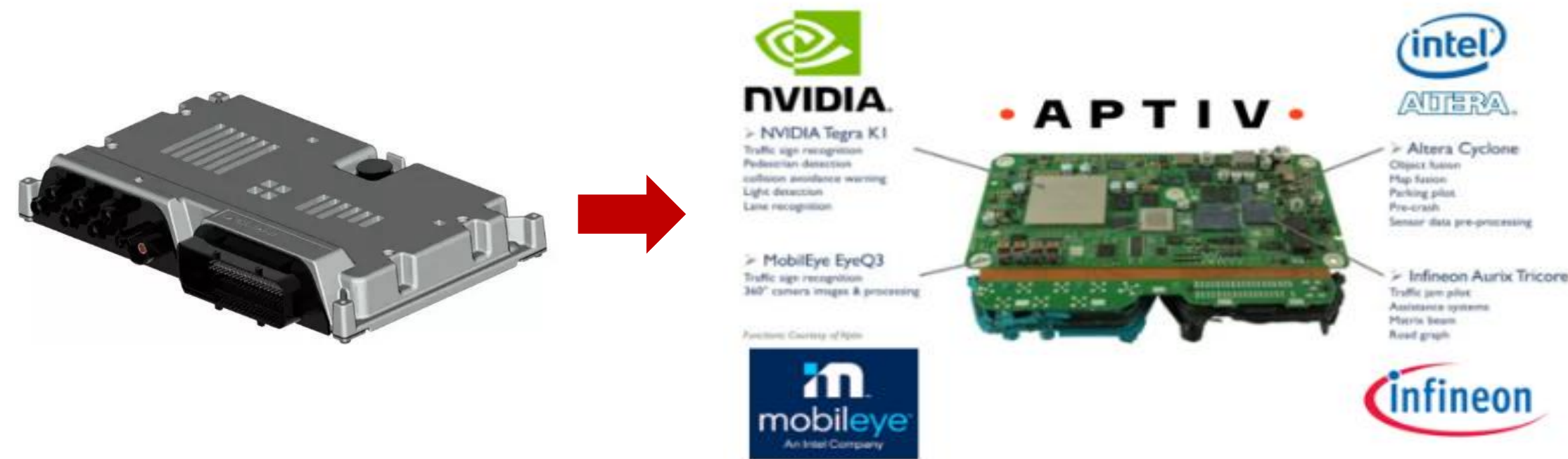
图：多域控制器zFAS的产品构造
