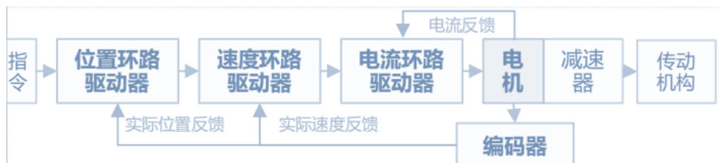
图21：伺服系统负责驱动机器人的运动，由伺服驱动器、伺服电机及编码器组成
